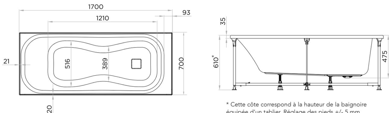
\* Cette côte correspond à la hauteur de la baignoire équipée d'un tablier. Réglage des pieds +/- 5 mm.
