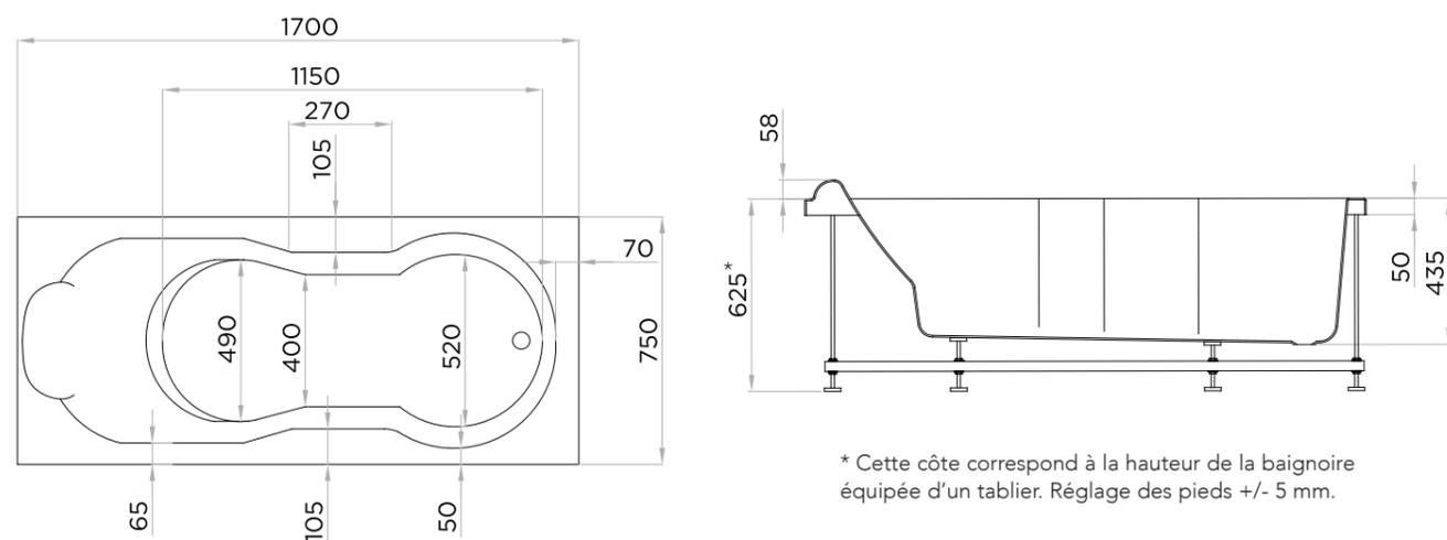
\* Cette côte correspond à la hauteur de la baignoire équipée d'un tablier. Réglage des pieds +/- 5 mm.
