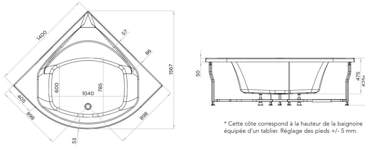
\* Cette côte correspond à la hauteur de la baignoire équipée d'un tablier. Réglage des pieds +/- 5 mm.
