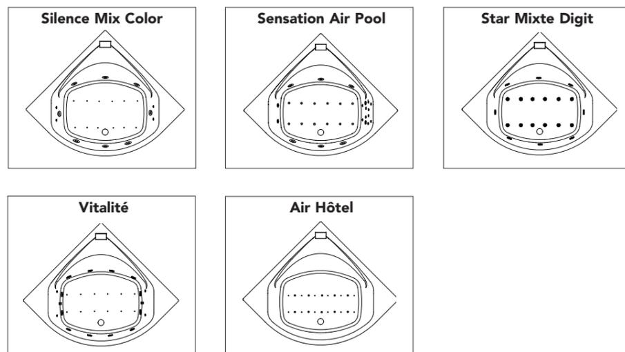
Emplacement des moteurs : sous la tête pour les systèmes Air Hôtel, Silence Mix Color et Star Mixte Digit / Pompe sous la tête et cartes + soufflerie aux pieds pour les systèmes Sensation Air Pool et Vitalité
