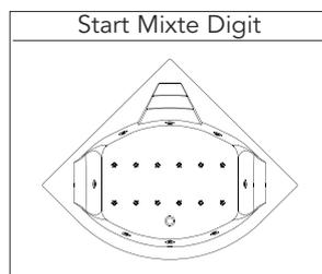
*Emplacement des moteurs : sous la tête pour les systèmes Air Hôtel, Silence & Air, Mix Color et Star Mixte Digit / Pompe sous la tête et cartes + soufflerie aux pieds pour les systèmes Sensation Air Pool et Vitalité*
