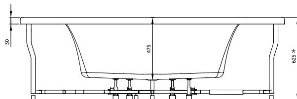
\* Cette cote correspond à la hauteur de la baignoire équipée d'un tablier. Réglage des pieds +/- 5 mm.
